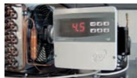
Centralina digitale per stabilire la temperatura interiore con funzione di on/off e presa di avviamento alla linea principale.
