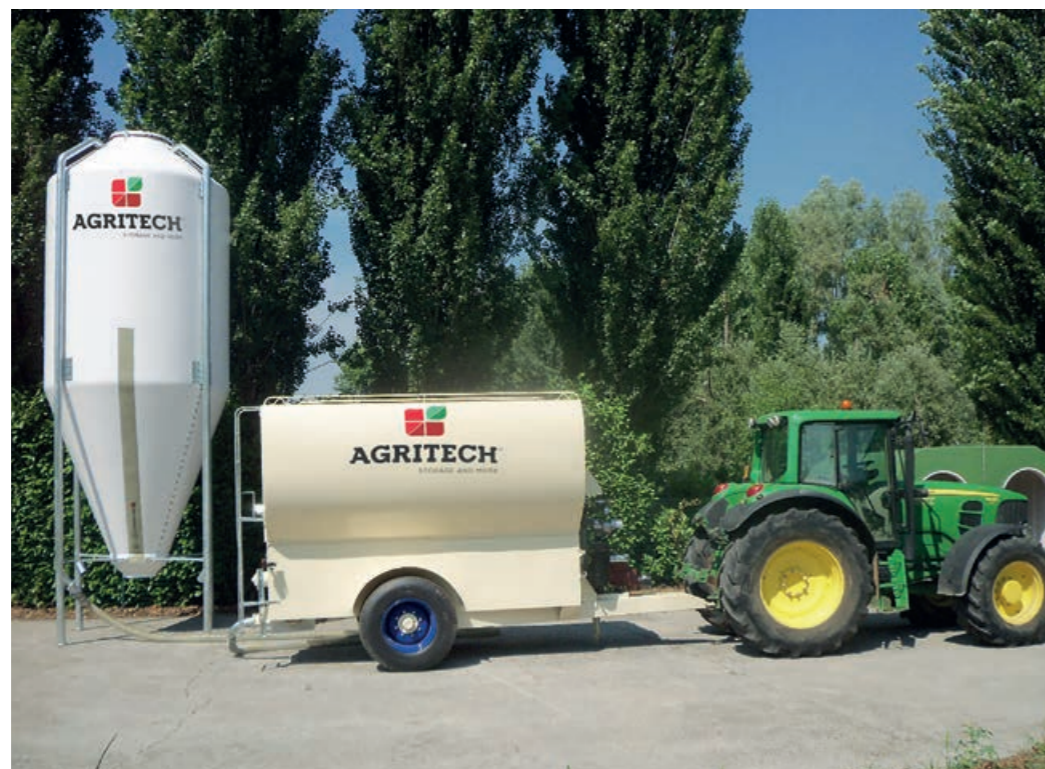
Cisterna con sistema di scarico pneumatico Mod. AP - Tank with pneumatic discharge system Mod. AP - Remorque avec dechargement pneumatique Mod. AP Tank mit pneumatischer Produktentnahme Mod. AP - Резервуар с пневматической системой разгрузки Модель AP
