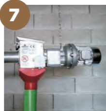
7 Gruppo traino con motoriduttore e caduta finale integrata. Drive unit complete with gear motor with one feed drop integrated. Groupe d'entraînement avec réducteur et sortie finale intégrée. Antriebsstation mit Getriebemotor und integriertem Endauslauf. Приводное устройство с редукторным двигателем и одним встроенным устройством для подачи корма
